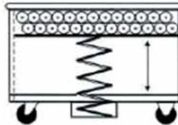
► La base del carro/container está compuesta por un muelle, el cual se eleva o baja en función de la presión que ejerce sobre él la carga. Este sistema evita esfuerzos innecesarios a la hora de cargar o descargar el contenido de la cuba.
